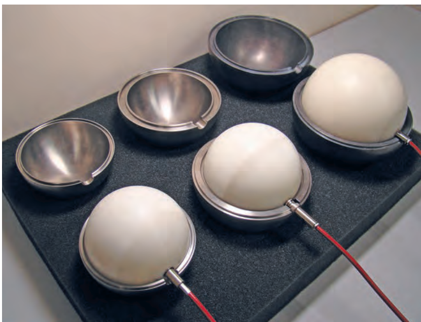
■ Sphères de Bonner, avec des coquilles métalliques, utilisées dans le spectromètre pour la mesure des neutrons de haute énergie.
