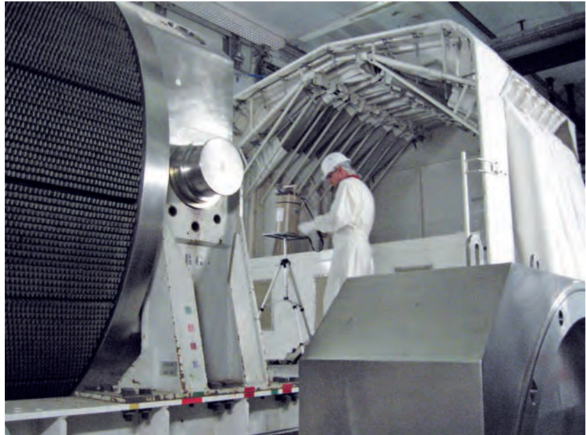
■ Mesures réalisées par l'IRSN pour caractériser l'exposition neutronique à certains postes de travail dans une centrale d'EDF.
