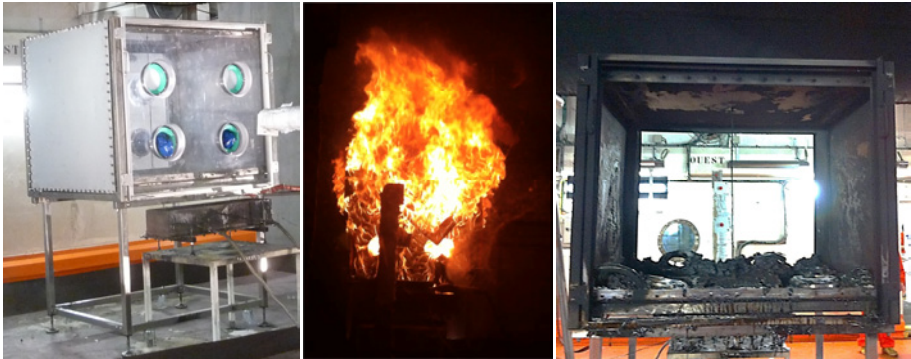
Figure 22. Illustration photographique d'une boîte à gants avant (gauche), pendant sa dégradation (milieu) sous la hotte SATURNE puis à l'issue de sa dégradation sur l'installation DIVA (droite).
