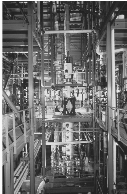
Figure 3.1. La boucle BETHSY (REP 900 MWe, trois boucles). © Georges Goué/IRSN — Source CEA (à gauche), CEA (à droite).
