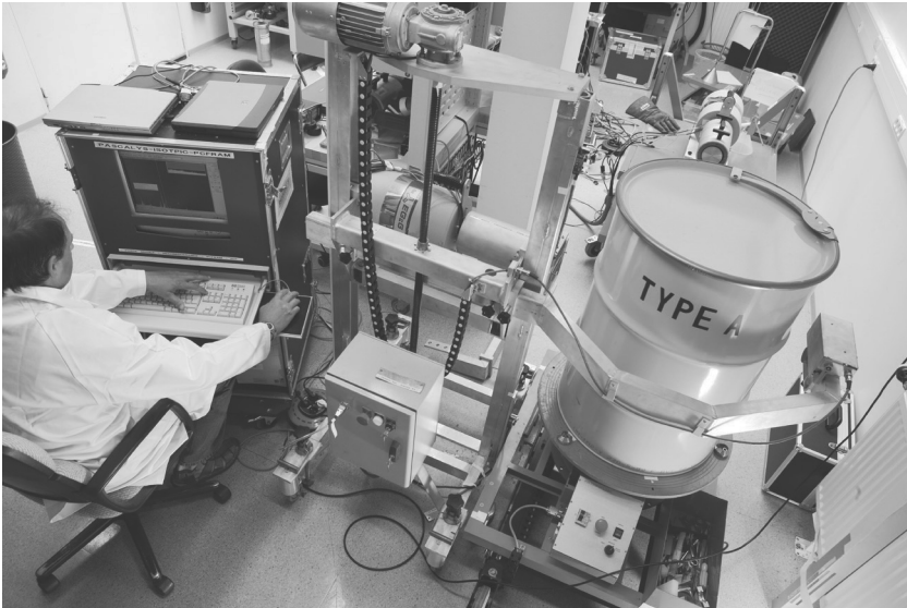
Figure 22. Dispositif de mesures de matières nucléaires par spectrométrie gamma réalisées à l'IRSN, Fontenay-aux-Roses, France. © Noak/Le bar Floréal/IRSN.
