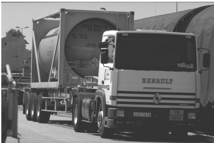
Figure 17. Camion de transport de nitrate d'uranyle en iso conteneur LR 65. Manche. © EURODOC CENTRIMAGE, AREVA.
