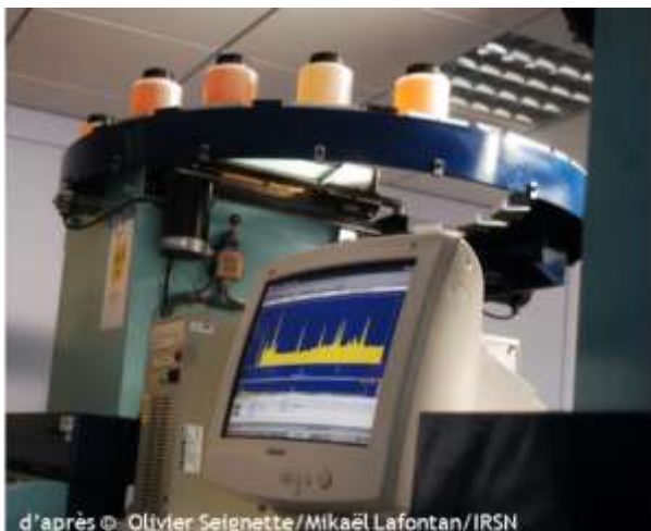
Figure 27 - Mesure de la radioactivité au sein d'échantillons urinaires par spectrométrie \gamma dans le cadre d'analyses radiotoxicologiques
