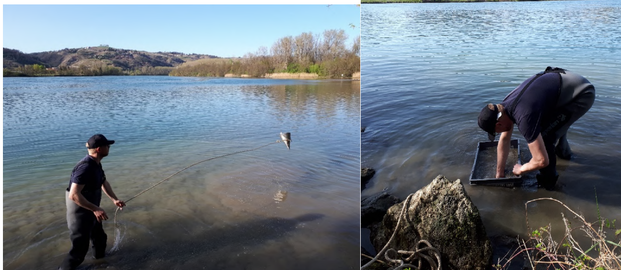
Figure 25 – Un cône de Berthois permet de prélever les sédiments (cliché de gauche). Ceux-ci sont filtrés pour récolter les corbicules vivant sur les fonds du Rhône (cliché de droite)
