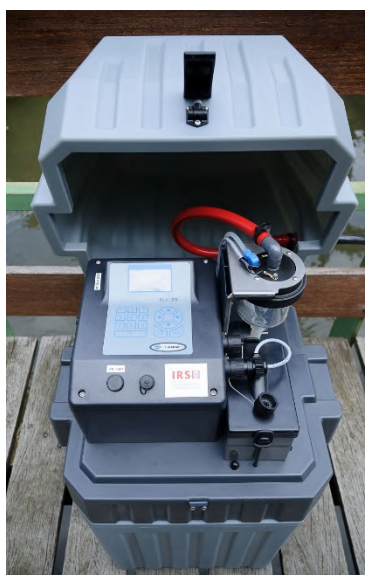
Figure 10 - Collecteur automatique d'eau (Bülher 2000) installé aux stations amont et aval de la centrale nucléaire de Saint-Alban Saint-Maurice l'Exil
