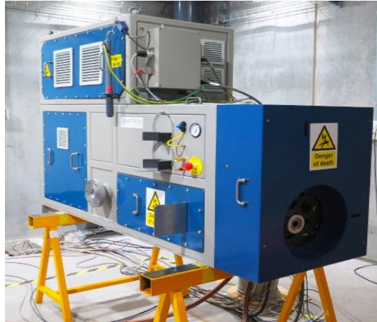
Figure 7. Illustration de l'accélérateur Oriatron eRT6 20 .
