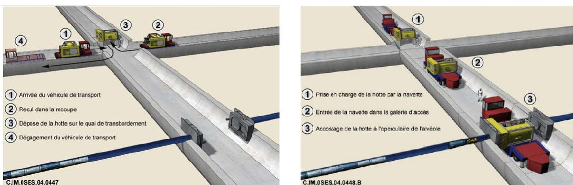
Figure 35 - Transfert d'une hotte de déchets C [2] et accostage de la hotte par la navette sur la tête d'alvéole [32].
