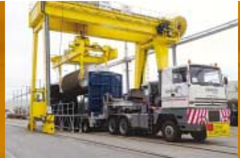
Au terminal ferroviaire de Valognes (Manche), transport d'emballages de combustibles usés.
