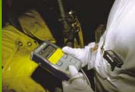
Dosimètre électronique à la centrale du Bugey (Ain).
