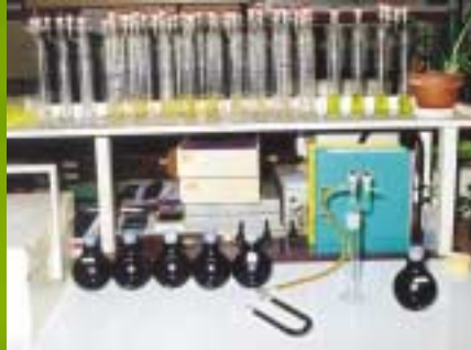
Dispositif de mesure du radium 226 par émanation utilisé dans le cadre du contrôle radiologique des eaux de boisson.
