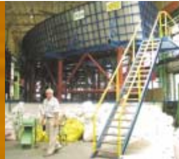
Boucle VITRA : étude du transfert horizontal et sédimentation au fond du bâtiment réacteur.
