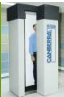
Anthropogammamétrie : détection de radionucléides externes et/ou internes à la centrale du Blayais (Gironde).
