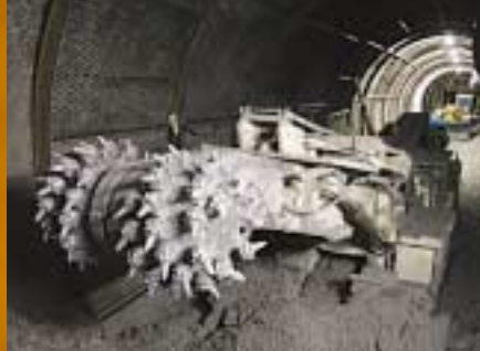
Tête de la machine de creusement à attaque ponctuelle.
