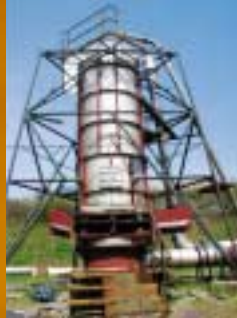
Les essais sur la boucle MANON ont permis de mieux apprécier le comportement des filtres.
