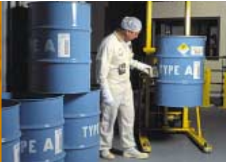
Contrôle de radioactivité des fûts de stockage de déchets nucléaires à la centrale de Nogent-sur-Seine (Aube).
