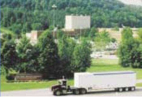
Transport d'effluents liquides radioactifs. Citerne LR56 avec tracteur routier. Oak Ridge (États-Unis).
