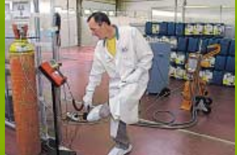
Contrôle de contamination vestimentaire en sortie de zone contrôlée.
