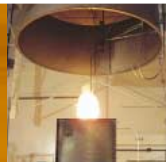
Essai du programme CARMELA visant à étudier la combustion des armoires électriques.
