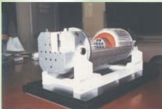
Transport de matière fissile : TN 12/2 Configuration réelle et modélisation MORET 4
