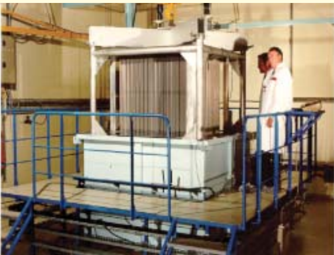
Exemple 3 : Mise en place du réseau HTC dans la piscine de l'Appareillage B
