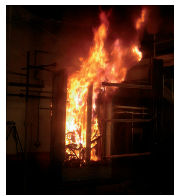
Feu d'armoire électrique
