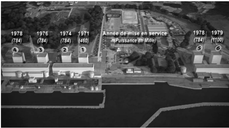
Figure 36.1. Le site et les réacteurs de la centrale de Fukushima Daiichi. Source « L'analyse de l'IRSN du déroulement de l'accident de la centrale nucléaire de Fukushima Daiichi ». Jean-Yves Pipaud/Patrick Barra/Epsim/Médiathèque IRSN.
