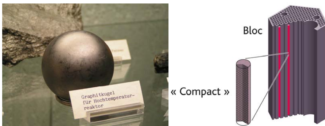
Figure 5 Boulet (photo de gauche), bloc et « compact » (photo de droite).
