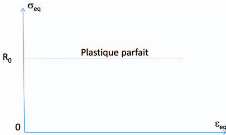
Figure 23. Comportement de référence pour l'analyse limite : plasticité parfaite.
