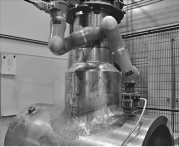
Figure 10.8. Contrôle d'un piquage à l'aide d'un traducteur conforme (conférence Cofrend 2014 – stratégie pour l'inspection robotisée de composants nucléaires : de la conception du contrôle aux résultats expérimentaux). © CEA.
