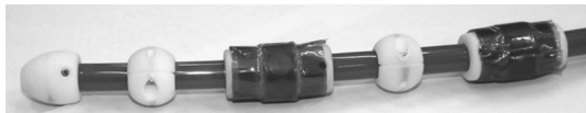
Figure 10.10. Prototype de sonde souple à courants de Foucault pour inspection de cintres de tubes de GV. © DR.
