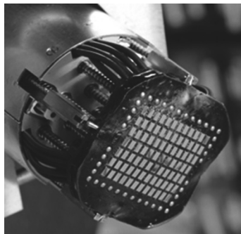
Figure 10.7. Un prototype du traducteur « conformable » – brevet IRSN/CEA. © IRSN/CEA.
