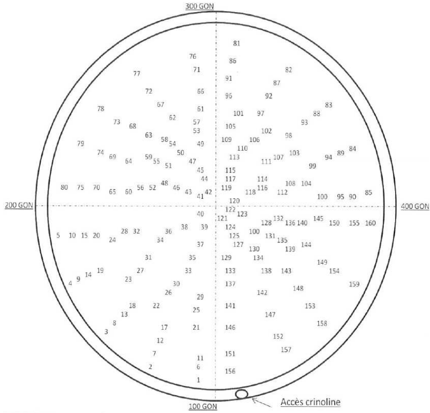
Figure 7 : Plan de localisation des frottis réalisés dans le cadre de l'élaboration de la cartographie de contamination pour la tranche 1 du CNPE de Belleville - Dôme
