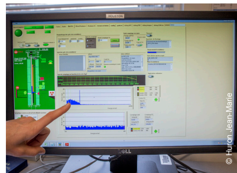
Ecran de contrôle-commande à distance d'un poste de spectrométrie gamma.
