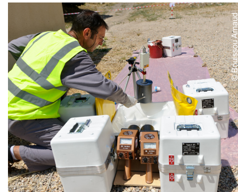
Technicien en radioprotection ajustant la position d'une source pour la mesure de sa longueur.
