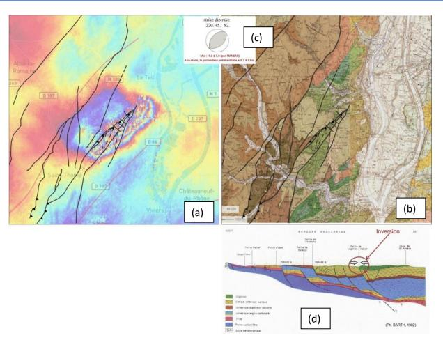
Figure 3 : (a) superposition des failles sur l'imagerie satellitaire (E. Mathot, BRGM), (b) carte géologique du secteur du Teil, (c) mécanisme au foyer (B. Delouis, Géoazur) montrant l'aspect compressif de la déformation sismique, (d) coupe géologique du secteur réalisée en travers de la faille. Source : Bernard Mercier de Lépinay (Géoazur), coupe de Philippe BARTH, 1982, dans le cadre du programme GPF, Géologie Profonde de la France
