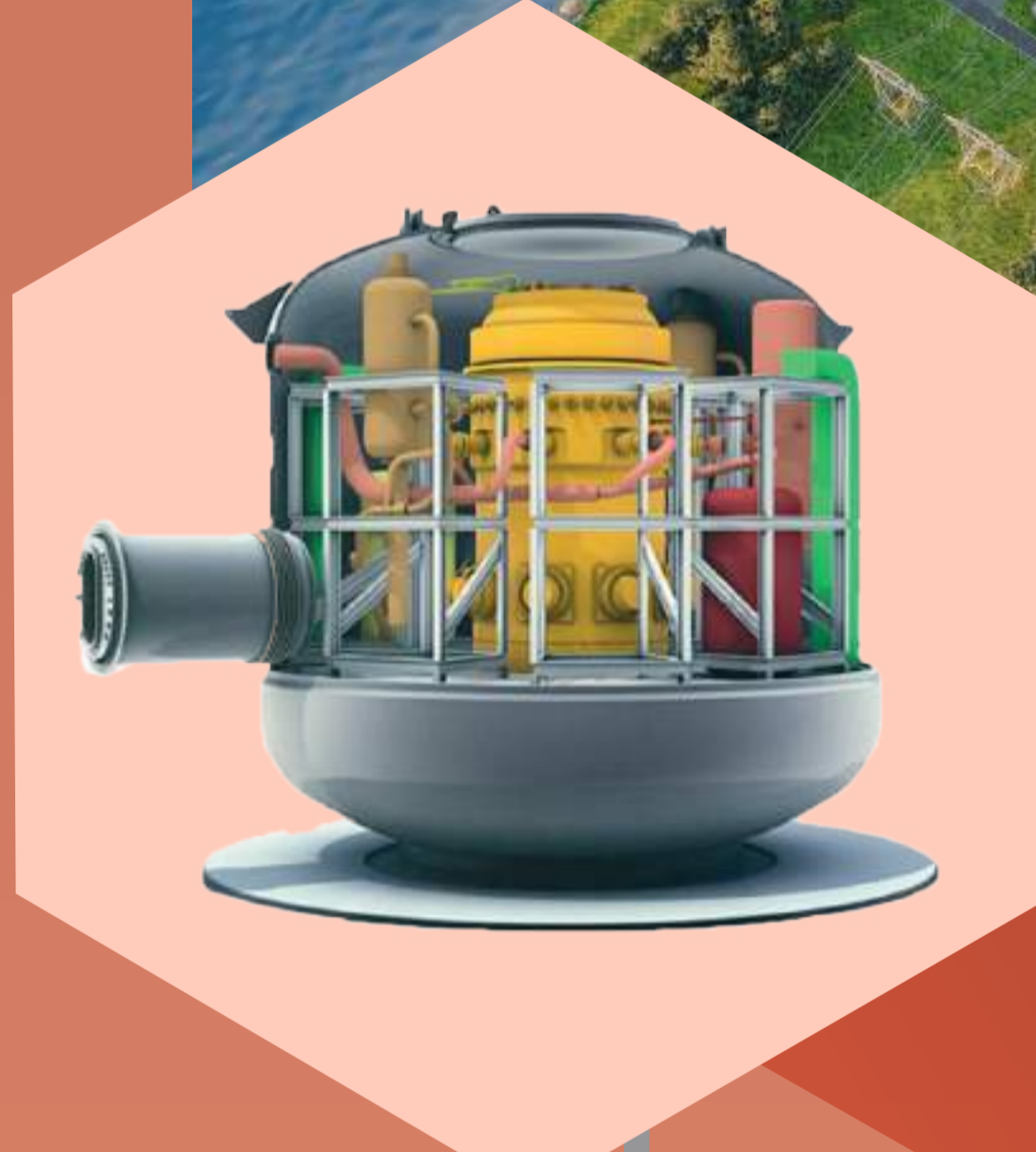
Chaudière et enceinte NUWARD™ dans la vue d'ensemble du bâtiment nucléaire principal.
