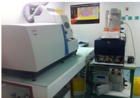
Figure 1. Couplage automatisé de la séparation radiochimique avec la mesure par ICP-MS
