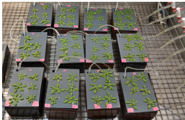
Figure II.2 : Dispositif de culture hydroponique. Entre 5 et 6 plantes peuvent être cultivées dans la même boîte de 1L. Les parois des boîtes sont opaques afin de limiter les perturbations que peut causer l'éclairage sur les racines. La solution est aérée et homogénéisée par bullage.
