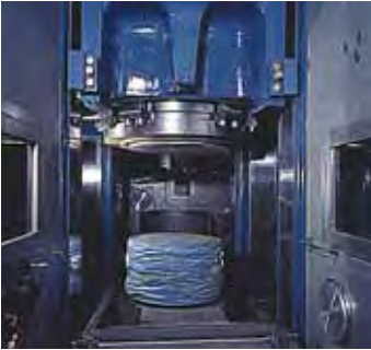
Compactage de fûts.
