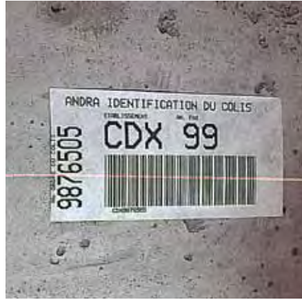
Chaque colis possède son code-barres précisant l'origine, le niveau et la nature de la radioactivité qu'il contient.
