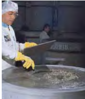
Enrobage de ciment.
