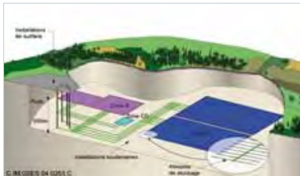
Coupe du projet d'installation de stockage profond.
