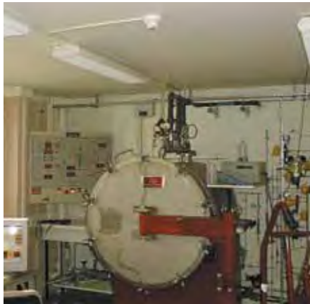
Banc d'étalonnage radon de l'IRSN.
