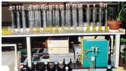
Dispositif de mesure du radium 226 par émanation suivie d'une mesure du radon 222 dans des ballons sous vide aux parois recouvertes de sulfure de zinc.
