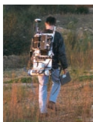
Le système SOCRATE (Système d'Observation et de Cartographie de la Radioactivité Autonome et Transportable pour l'Environnement) fournit en temps réel le débit de dose gamma mesuré à 80 cm du sol en fonction de la position donnée par un GPS différentiel.
