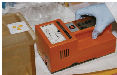
Contrôle direct de surface à l'aide d'un contaminamètre.
