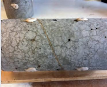
Béton dégradé par une réaction sulfatique interne.
