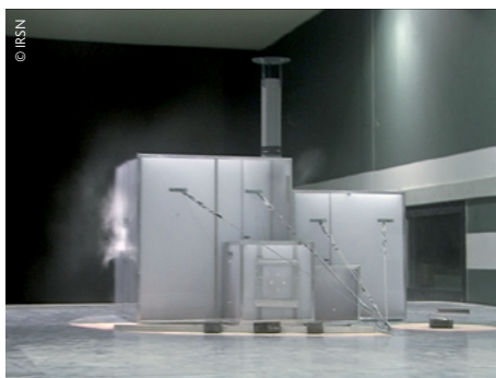
Visualisation par injection de fumée d'une inversion de fuite externe lors d'un essai en soufflerie pour une vitesse de vent de 105 km/h environ.
