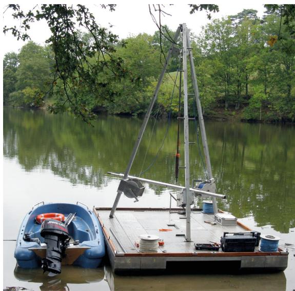
Plateforme de carottage sur barge UWITEC® pour le prélèvement de carottes longues.
