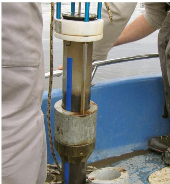
Carotte de sédiments réalisée avec un carottier gravitaire à main UWITEC®.
