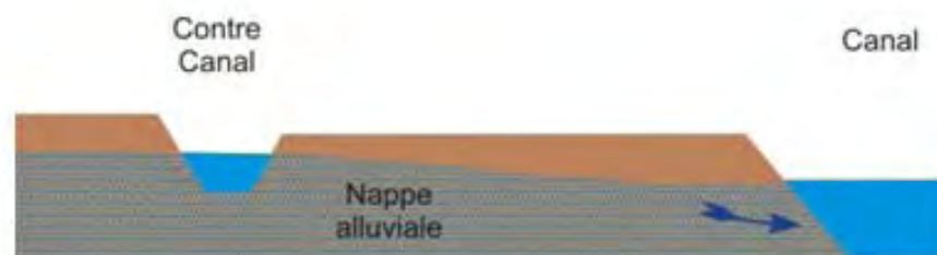
Figure 8 : Schéma de principe des écoulements au voisinage du canal de fuite - influence du canal de réalimentation (contre-canal)
