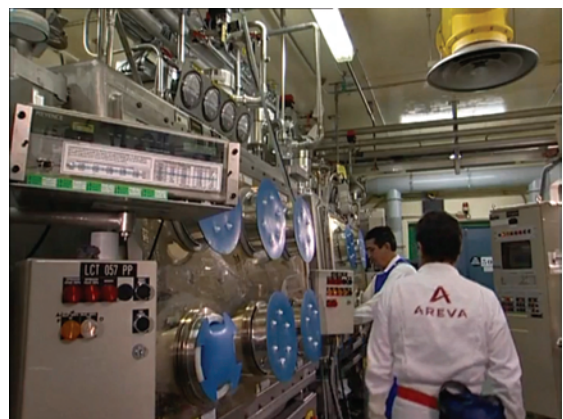
Boîtes à gants du poste LCT du laboratoire de l'usine MELOX
