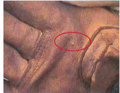
Gant percé lors de l'incident du 14 juin 2010
