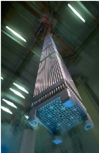
Un assemblage combustible
