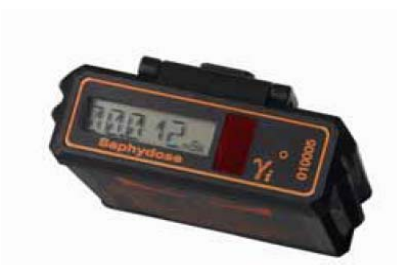
Exemple de dosimètre opérationnel - mesure et affichage numérique - Alarme et préalarme De l'équivalent de dose intégré et du débit d'équivalent de dose \gamma et X en temps réel
