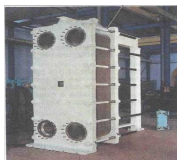
Echangeur thermique eau/eau
