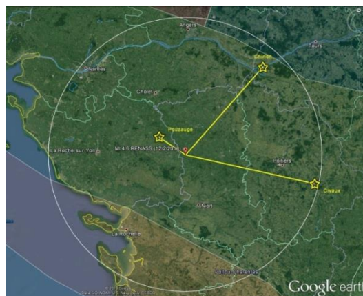
Figure 3 : Localisation de l'épicentre du séisme de Saint-Hilaire-de-Voust et des installations nucléaires les plus proches (Pouzauges, Civaux et Chinon). Le cercle blanc représente un rayon de 100 km autour du séisme. Les contours blancs correspondent aux limites des zones sismotectoniques du zonage IRSN le plus à jour, chaque zone est définie comme étant homogène du point de vue sismogénique.
