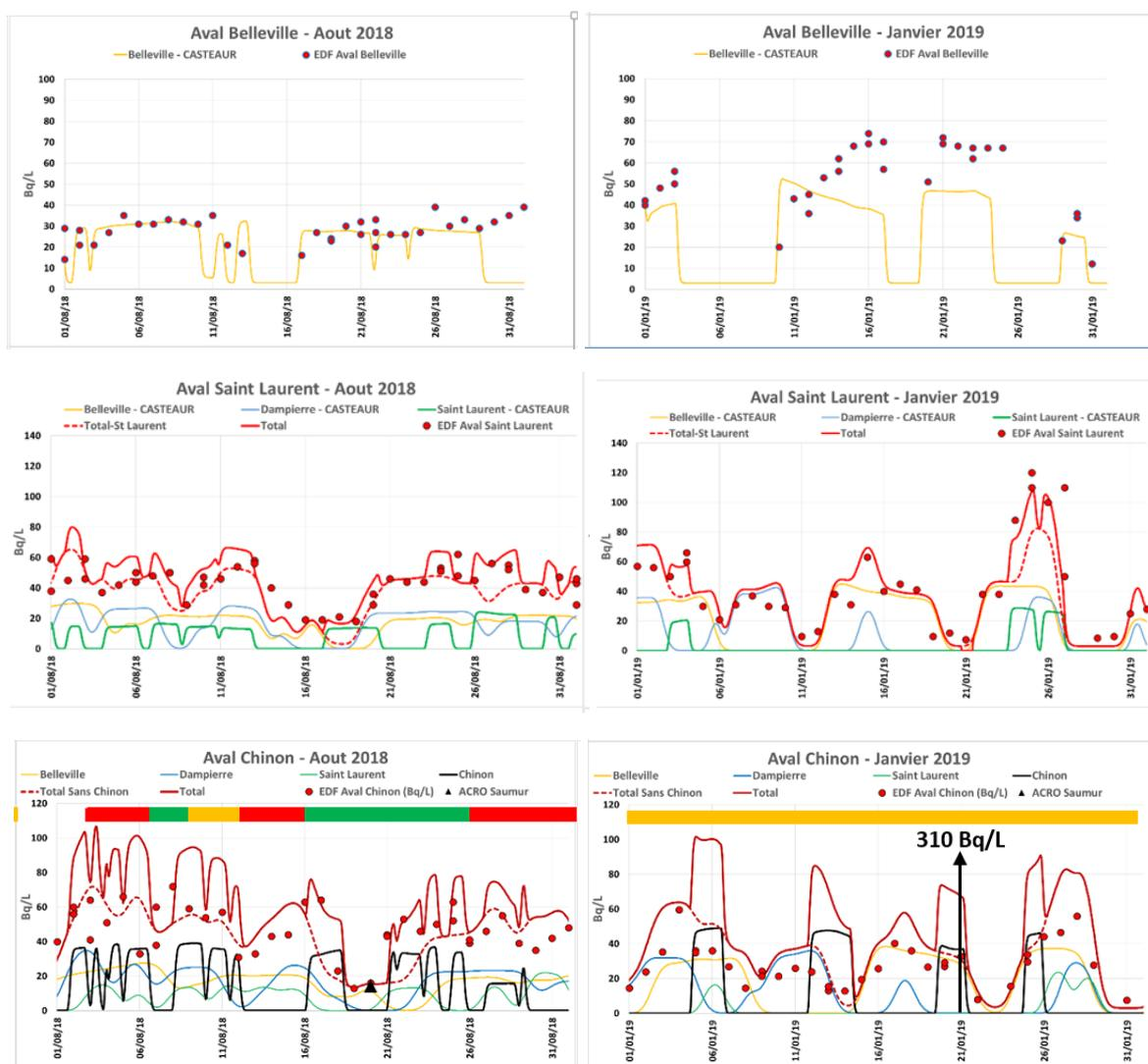
Figure 4 : Comparaison des teneurs en tritium calculées à partir des rejets (lignes continues) et mesurées par les systèmes de surveillance d'EDF (points rouges) en aval de trois centrales de la Loire durant les mois d'août 2018 et janvier 2019.
