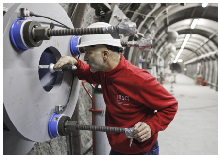
Insertion d'un noyau argileux instrumenté dans un forage d'essai.
