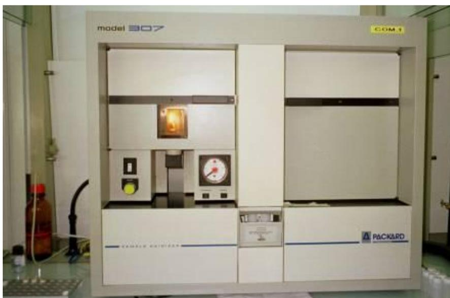
Figure 5 -Dispositif « oxydiser » pour la combustion des échantillons solides et la récupération du tritium avant analyse
