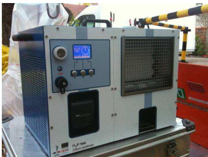
Figure 2 Condenseur de vapeur d'eau H3R-7000 (marque SDEC) utilisé lors de la campagne de prélèvements
