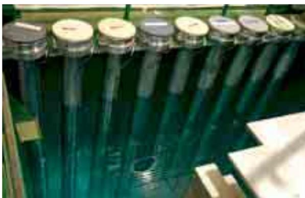
Réacteur PHÉBUS : piscine de stockage des dispositifs d'essai.
