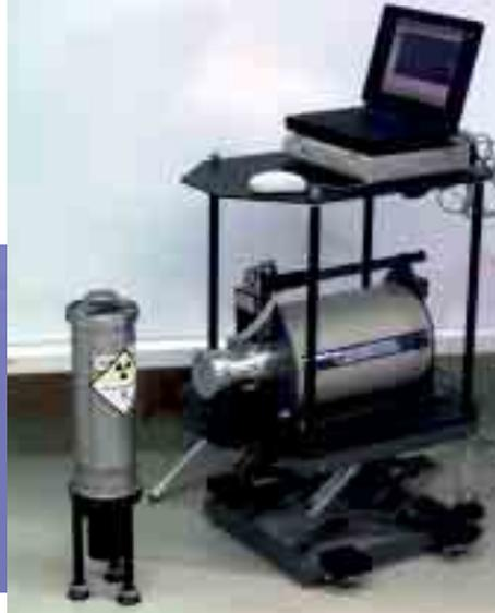
Détermination de la composition isotopique du plutonium.
