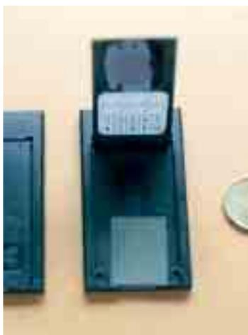
Dosimètre radon à kodalpha.
