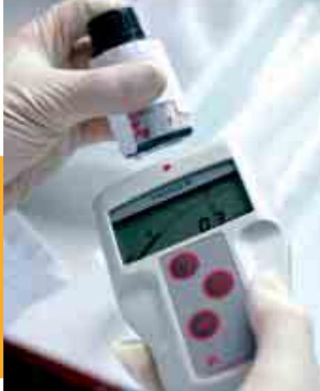
Contrôle de débit de doses sur un échantillon radioactif.
