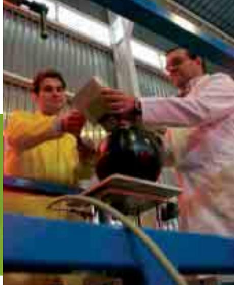
Placement de l'appareil de dosimétrie neutron devant CANEL.
