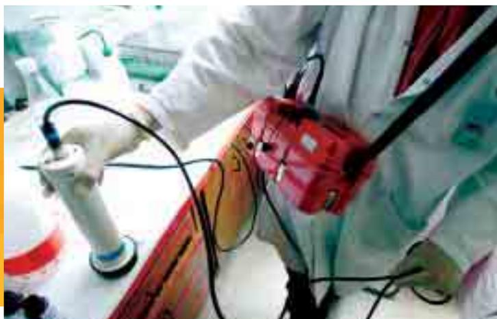
Laboratoire des échantillons actifs : contrôle radiologique de non contamination d'une paillasse de sorbonne.
