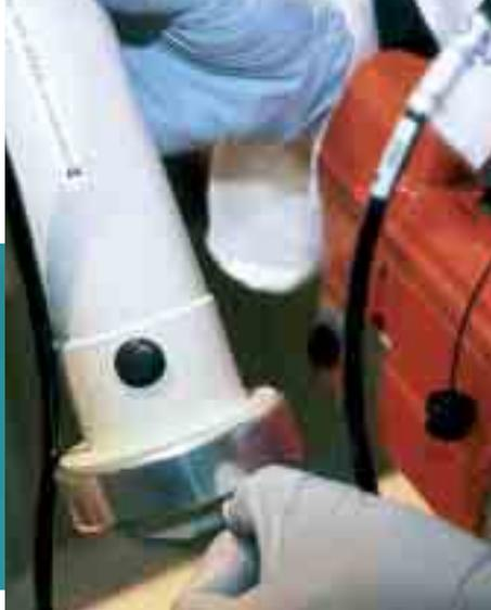
Contrôle d'un filtre à l'aide d'un radiamètre.
