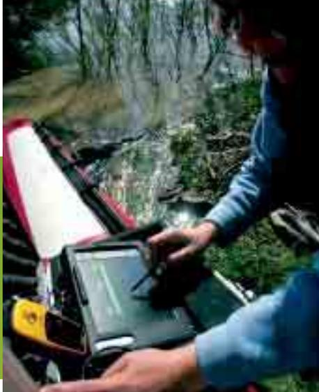
Ardoise électronique permettant le référencement des échantillons prélevés dans l'environnement.
