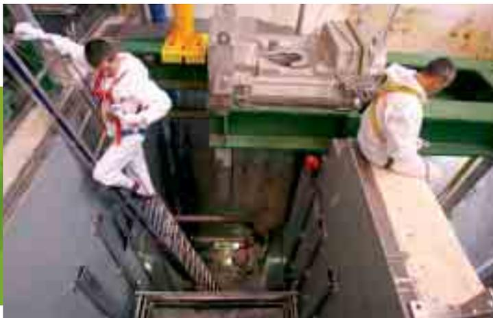
Bac d'entreposage des dispositifs d'essais de l'installation CABRI.
