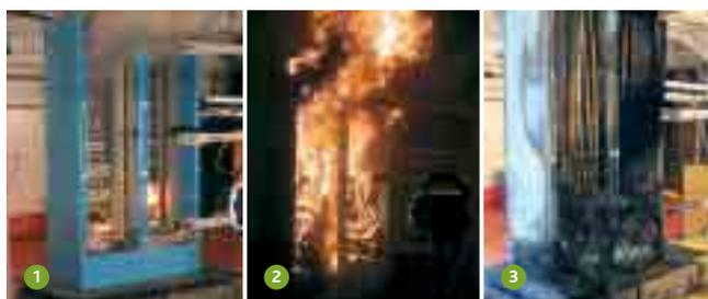
Essai visant à définir les modes de combustion des armoires électriques.
