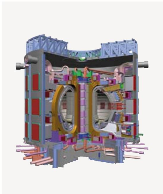
ITER : vue en coupe de la chambre toroidale bobine magnétique.
