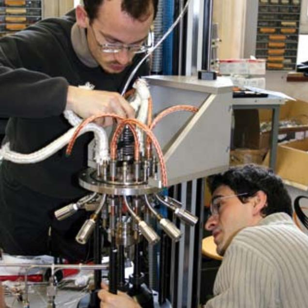
Assemblage du réacteur (en bas) et des fours (en haut).
