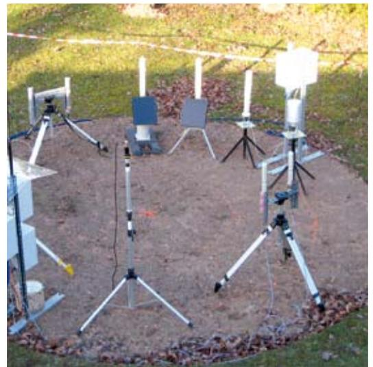
Plate-forme d'évaluation des instruments de mesure du débit de dose gamma ambiant en vue de la modernisation du réseau Téléray.
