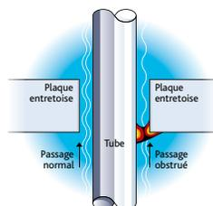
Il est apparu en 2005 que, dans certains générateurs de vapeur, les passages aménagés entre les tubes et les plaques entretoises pour la circulation de l'eau et de la vapeur avaient été progressivement obstrués par des dépôts d'oxydes, principalement de la magnétite.
