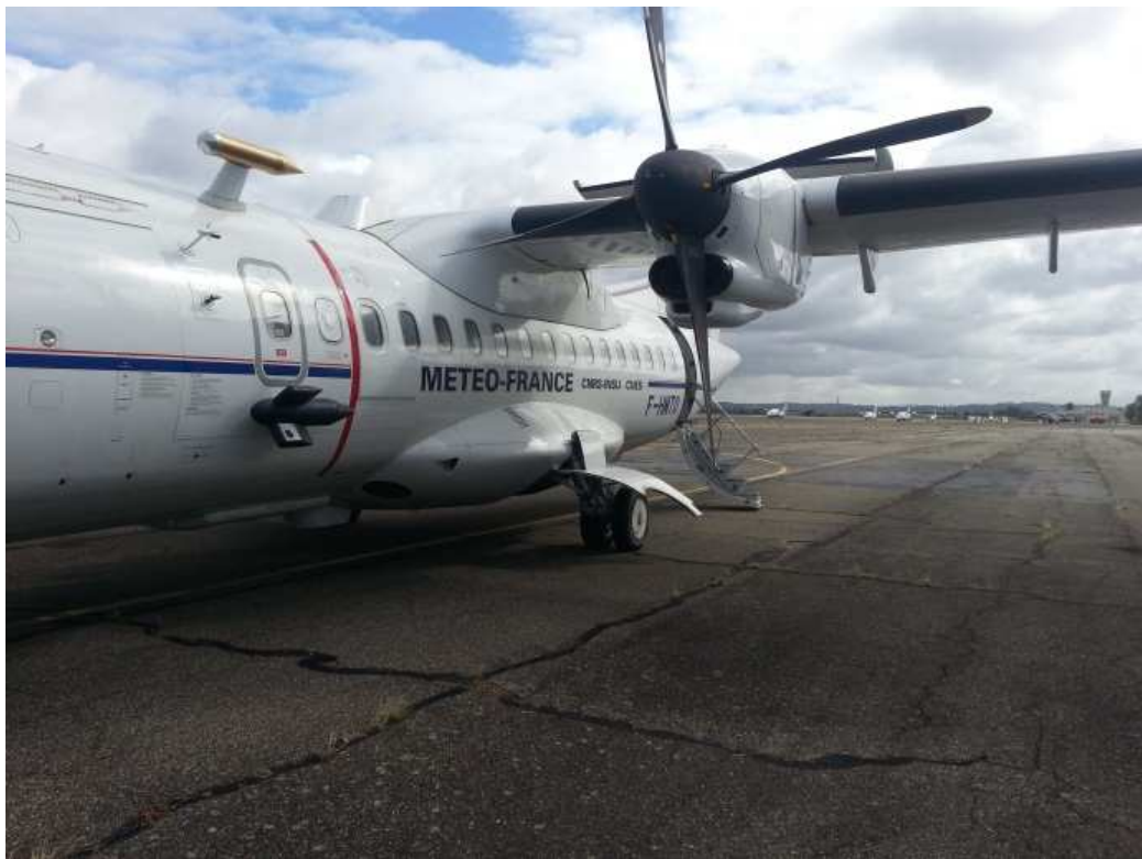
Figure 50. Vue de la sonde ALIDS sur l'ATR-42 avant décollage
