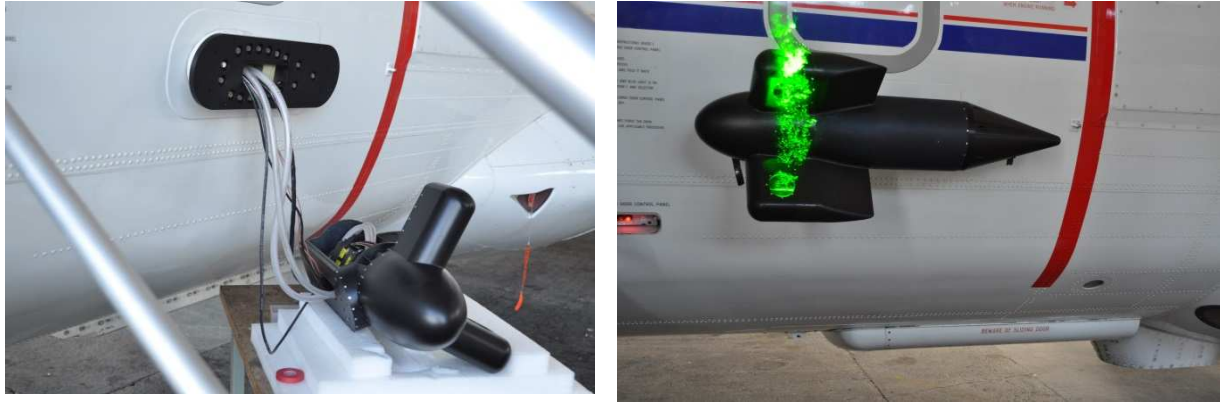
Figure 49. Vue de de l'intégration de la sonde ALIDS sur l'ATR-42 de SAFIRE et des essais au sol
