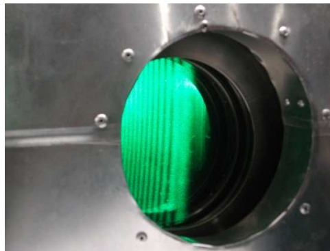
Figure 21. Figure d'arc-en-ciel standard obtenu pour une goutte d'eau millimétrique dans TOSQAN pendant la phase de réglage
