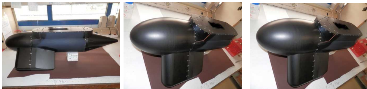
Figure 48. Vue de la structure mécanique de la sonde ALIDS avant intégration des composants optiques et électroniques
