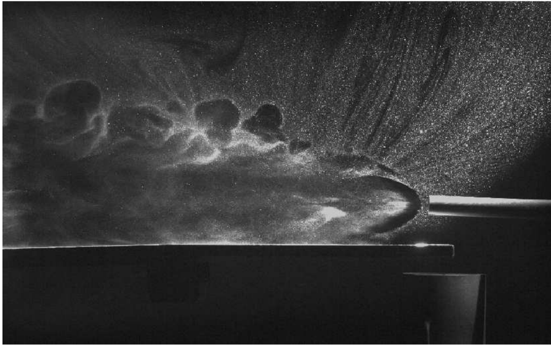
Figure 60. Visualisation du jet d'entrée d'air dans l'enceinte sous vide primaire et de l'onde de choc résultante
