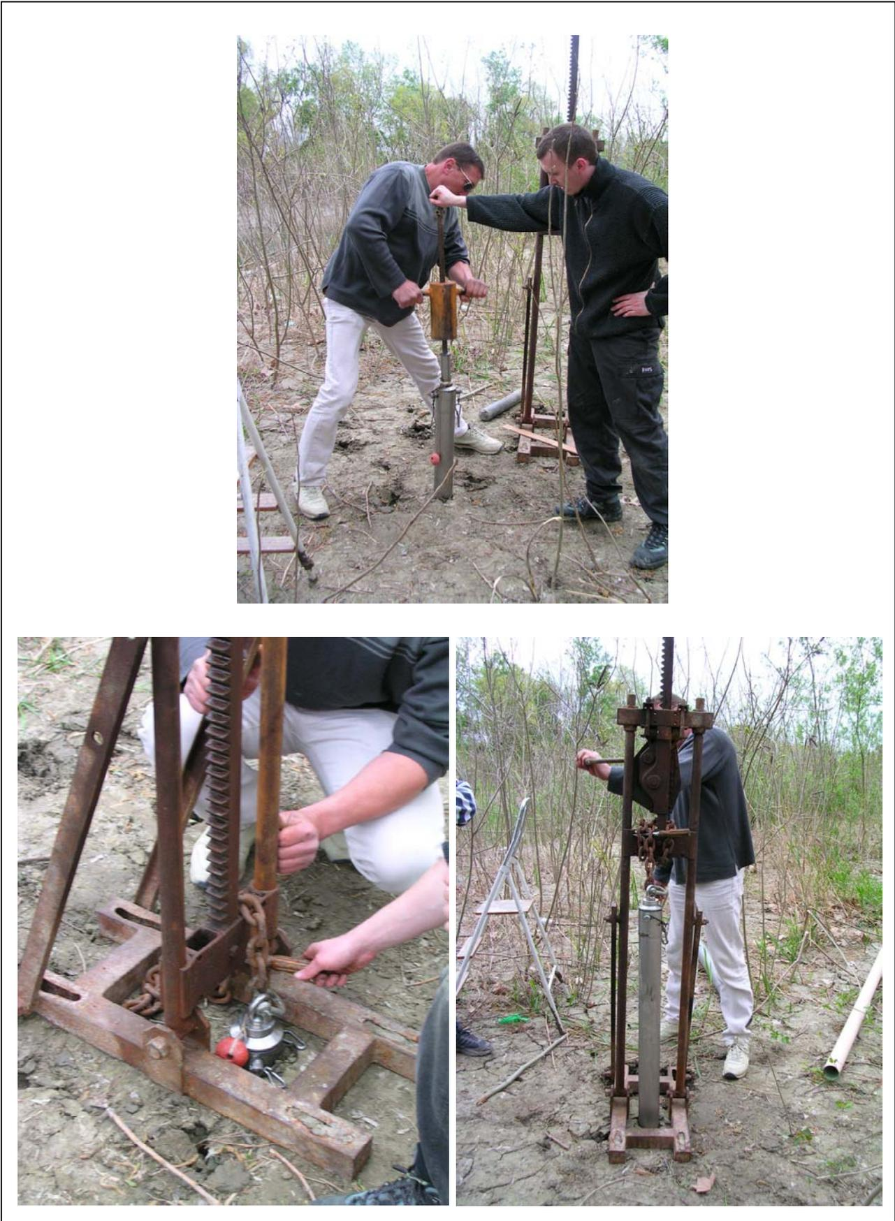
**Figure 2-18.** Photos de la campagne de carottage d'avril 2003, sur le site de Barriol. Le carottier à percussion photographié a permis l'obtention des carottes B3, B4 et B5.
