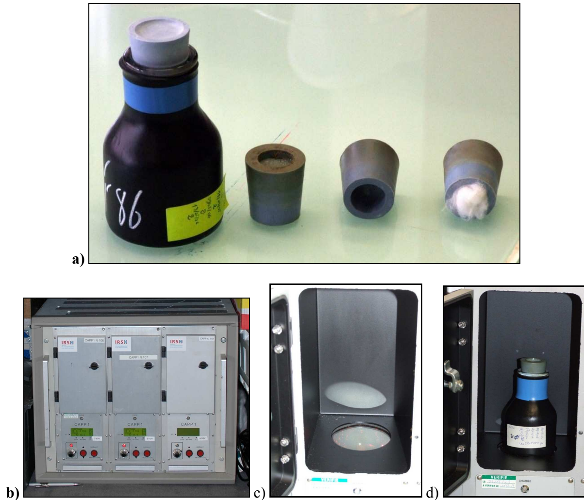
Figure II.21: a) Fiole scintillante et bouchon évidé b) Chambres de comptage équipées d'un photomultiplicateur c) Photomultiplicateur d) Fiole scintillante dans la chambre de comptage.
