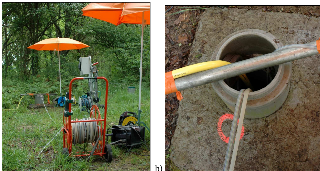
Figure II.19: Photos d'utilisation in situ du système de pompage dans les forages de Stang-er-Brune ; a) premier plan : pompe de prélèvement, arrière plan : pompe utilisée pour l'essai de pompage, b) Tuyaux des pompes rentrant dans le forage.
