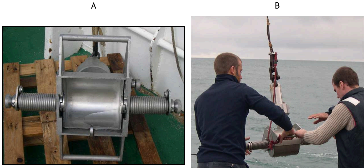
Figure 3.7 Benne Shipeck (prélèvement sédimentaire). A : benne armée. B : benne déclenchée après prélèvement.
