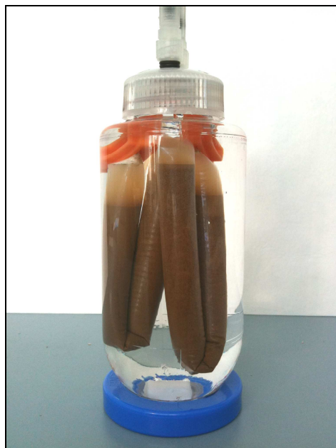
Figure 38 : photographie d'un réacteur à flux ouvert contenant un sac à dialyse renfermant une suspension de sol (description détaillée du montage en annexe 5.2)
