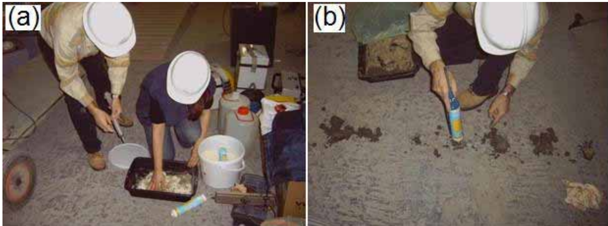
Figure II.22. (a) Préparation de la bentonite humide à partir d'argile sous forme de poudre, (b) Injection de la bentonite humide dans les microforages.
