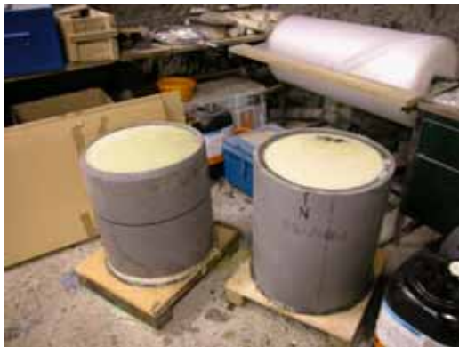
Figure ii. Echantillons d'argilite résinés afin d'éviter la désaturation (diamètre : 40 cm, hauteur : 50 cm)
