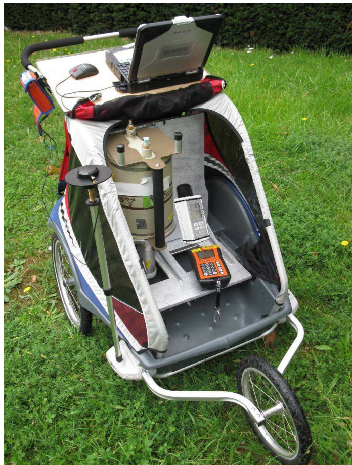
figure 4-9 : outil OSCAR entièrement monté dans un Chariot "Captain XL".
