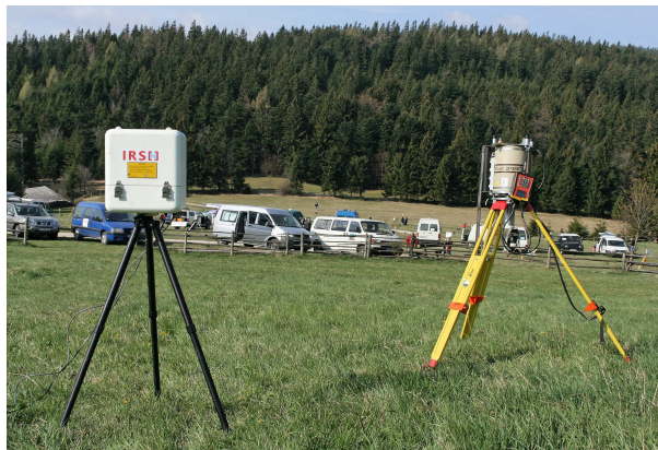
figure 1-2 : utilisation de la spectrométrie gamma in situ avec le détecteur germanium à droite et la chambre à ionisation à gauche (voir 1.3.3).
