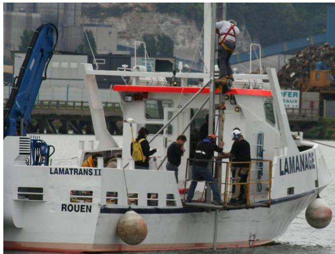
Figure 23 : Photo du carottier à percussion embarqué à bord de la barge Lamatrans II (carottage de juin 2010, Darse des Docks ; Crédit photo : Carole Dubrulle-Brunaud).
