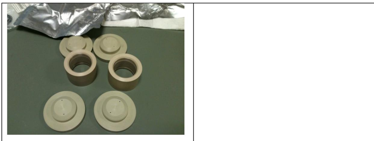
Figure 43 : Photographie de cellule PEEK.
