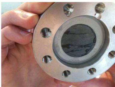
Figure 83 : Photographie de l'origine des fuites de la cellule TOAR proche fissure (bleu), les microfissures.
