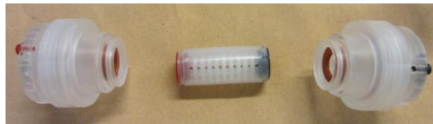
Figure 16 : Chambre de focalisation et réservoirs anodique/cathodique
