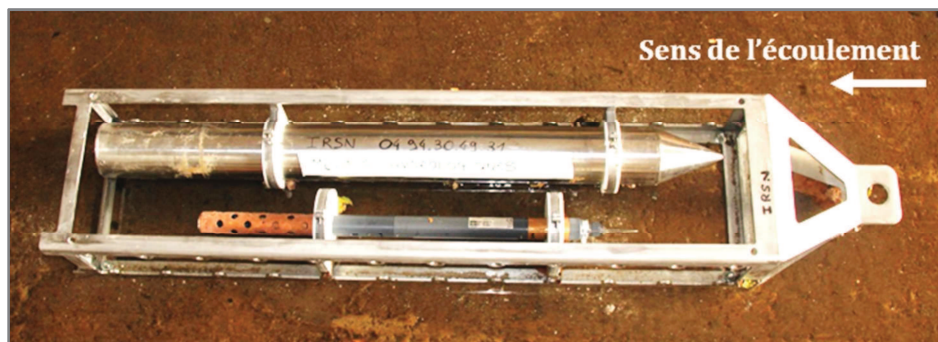
Photo III- 1: Sonde multiparamètres et piège a sédiments placés dans leur cage de protection à l'Eygoutier
