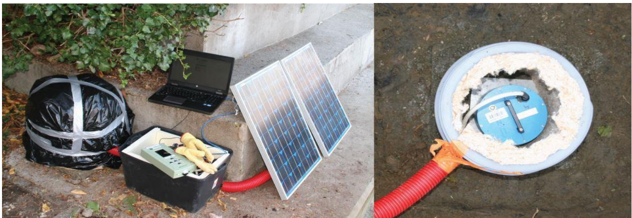
Figure II-27 : Photos d'une station sismologique composée du capteur, du numériseur ainsi que des panneaux solaires.
