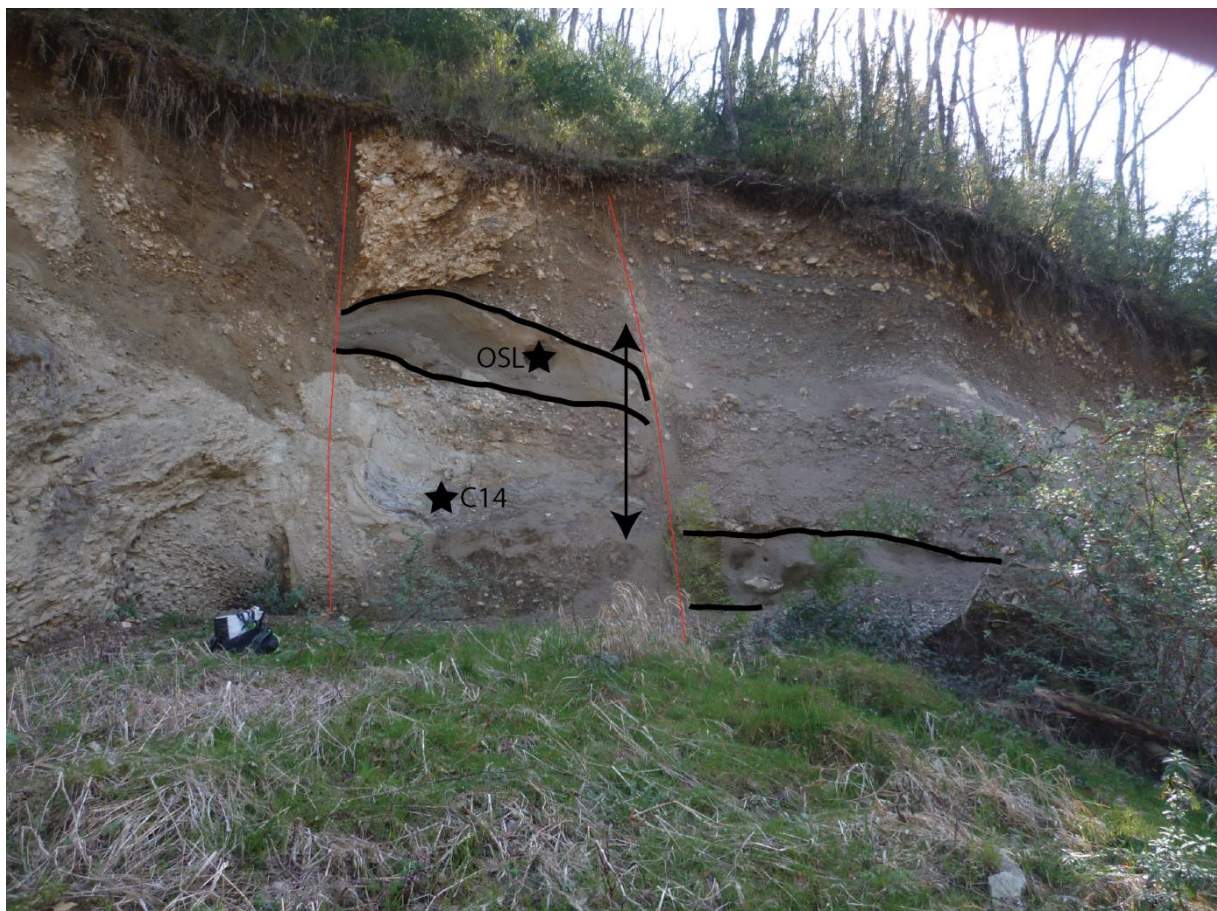
Figure IV-10 : Zoom sur l’affleurement de Brison Saint Innocent, cadre 2 sur la Figure IV-9. Les niveaux repères pour la mesure du décalage sont marqués en noir, ainsi que l’endroit où les échantillons ont été prélevés pour les datations.
