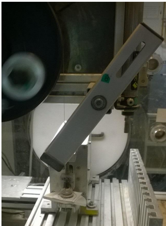
Figure 41 : Photo d'un échantillon de craie lors de sa découpe à la scie à fil (cellule C6)
